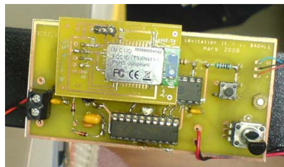
Fig 16. Maquette expérimentale, détail de la carte de commande et du circuit Bluetooth®.
