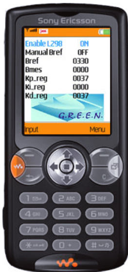
Fig 17. Midlet Java de l'interface de contrôle BT.
