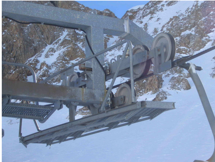
Figure 2. Passage de la pince d'un télésiège sous le premier galet d'un balancier.
