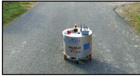
Figure 5. Essai en extérieur de localisation GPS/odométrie
