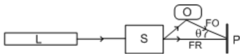
Fig. 1 : schéma de principe de réalisation d'un hologramme. L : source de lumière cohérente ; S : système optique permettant de diviser le faisceau en 2 et de les étaler pour qu'ils recouvrent l'objet O et le support photosensible P ; FR et FO : faisceaux référence et objet, respectivement ; \theta : angle moyen entre FR et FO.
