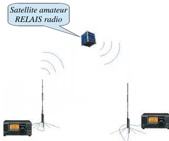
fig.1 Le satellite ne retransmet que les signaux contenant la tonalité subaudible
