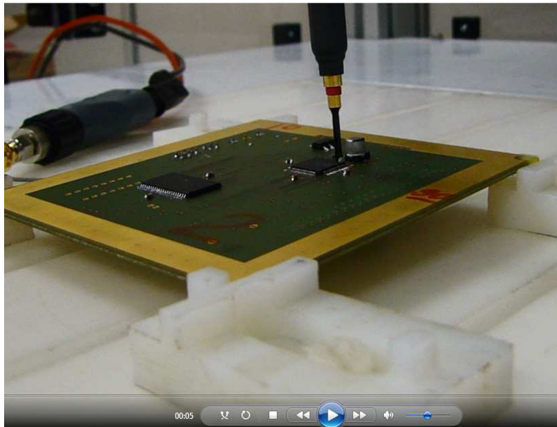
Fig. 8: Vidéo montrant la mesure par scanner champ proche de l'émission du circuit imprimé de test
