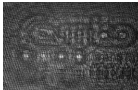
Fig. 2 Hologramme numérique d'un objet de phase généré via le SLM, la dimension de l'hologramme correspond à celle de la caméra CMOS : 4,2 \times 5,6 \text{ mm}^2
