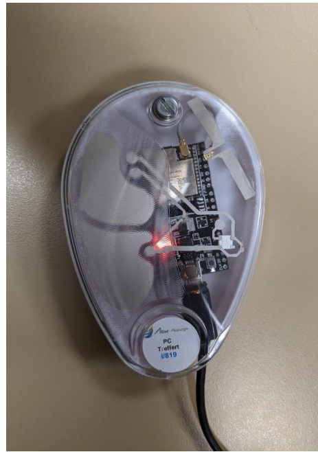
Fig.9. Test fonctionnel de la partie électronique avec une liaison sans fil d'une portée de 90m environ et un démonstrateur final typique.
