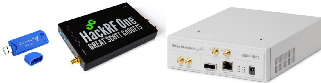
Fig.1. Quelques exemples de cartes SDR à bas coût, de gauche à droite : Clef TNT RTL-SDR, HackRF, plate-forme USRP N210 (Ettus Research par NI)
