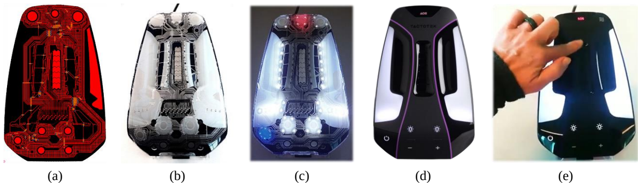
Fig.2. Exemple : (a) routage électrique ; (b) d'un système 3D ; (c) en fonctionnement ; (d) avec couche décorative, (e) d'une IHM ; réalisée en technologie plastronique ESS – Source : TactoTek ( imse ohcp ).
