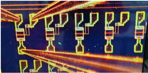
Fig.7. Jeu de NMOS réalisé par les étudiants. Le transistor W/L = 100/10 est sous pointes en vue de sa caractérisation électrique.
