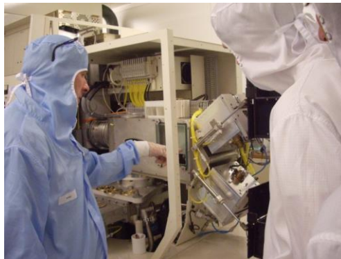
Fig.6. Implantation ionique des zones de source et de drain.
