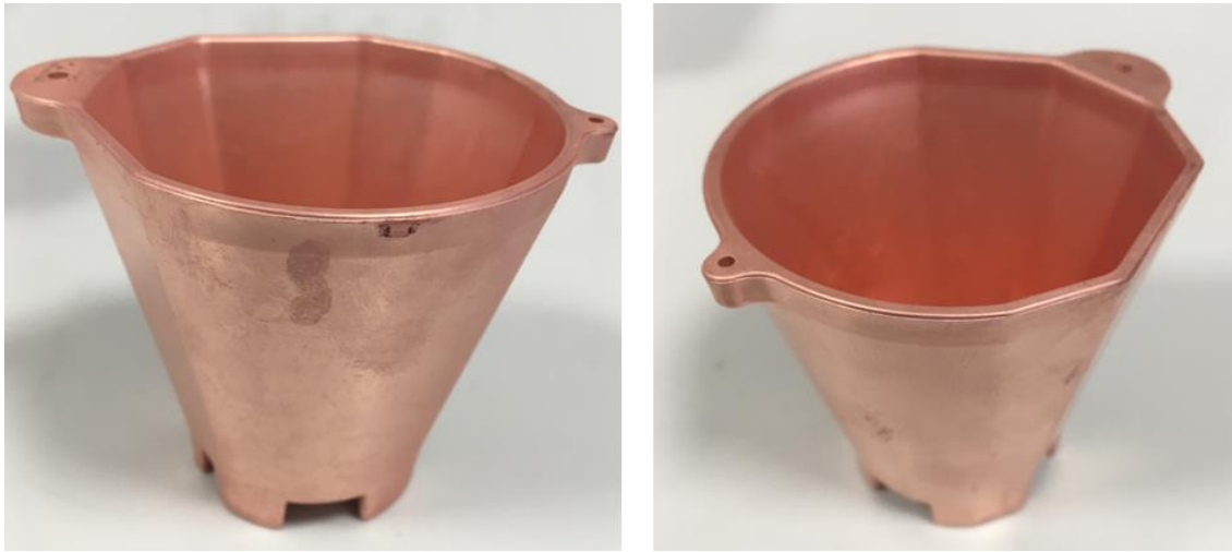
Fig 6: La tasse après 1 heure et demi de métallisation
