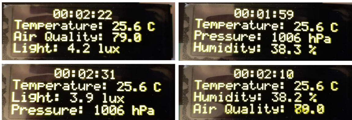
Fig.8. Montage montrant les quatre configurations d'affichage possibles. L'heure et la température sont affichées en permanence. La qualité de l'air, la luminosité, la pression atmosphérique et l'humidité quant à elles, sont affichées en une alternance contrôlée par un bouton-poussoir.
