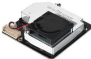
Fig.3. Description du capteur de particules SDS011.
