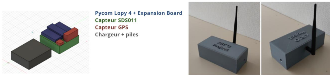
Fig.6. Modélisation 3D du prototype développé (à gauche) et réalisation avec antenne (à droite).
