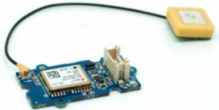
Fig.4. Description du module GPS Grove.
