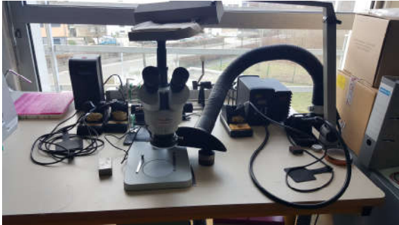
fig 11 : Station brasure classique, air chaud.
