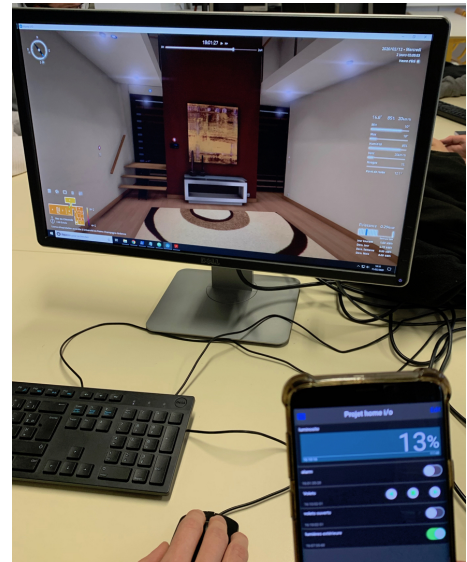
fig 5 : Communication entre un smartphone et Home I/O
