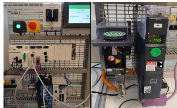
fig 5 : Platine cybersécurité des réseaux industriels
