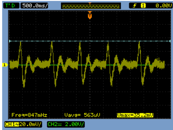
fig 4. Capture d'écran de l'oscilloscope où il capture le signal du capteur de pouls, avec sa composante DC (a) et sans (b).
