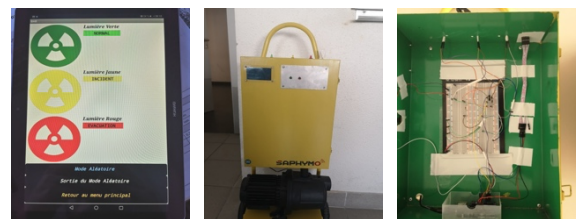
fig 5 : Tablette de commande, prototype de câblage de balise aérosols
