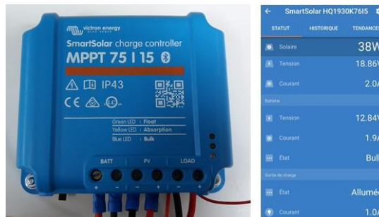
fig 5 : Le régulateur de charge et un exemple de supervision
