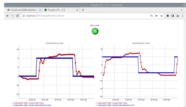
fig 6 : Exemple d'IHM de supervision simple sur Scada-LTS affichant un voyant pour indiquer la présence de la bille sur la table et des courbes de mesures des coordonnées de consigne et réelles de la bille sur la table.
