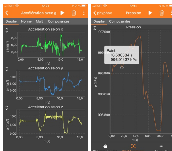
fig. 5 : Copie d'écran de l'application « phyphox » : à gauche une mesure d'accélérométrie 3 axes et à droite une mesure de pression lors du déplacement du téléphone de 1 m d'altitude.
