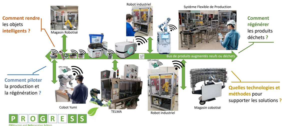
fig 2 : Schéma de principe de la plateforme ProGreSS 4.0
