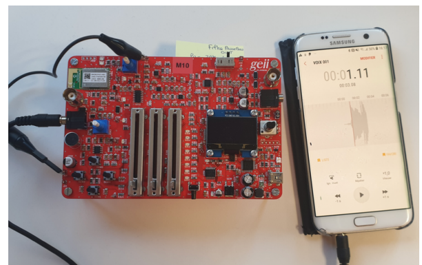
Figure 2 – Photo de la carte à base du STM32 relié à un téléphone générant un signal sonore
