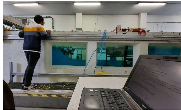
Figure 4. Le robot est relié directement à un ordinateur portable par l'intermédiaire d'un fin ombilical jaune que l'on aperçoit aux pieds de l'étudiant. Les vitres du bassin permettent d'observer le comportement du robot au cours des expérimentations.
