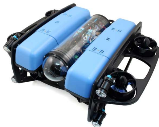
Figure 1. Le véhicule sous-marin BlueROV2 de la société Blue Robotics, utilisé pour les séances de travaux pratiques du module « Marine Mechatronics » du master MIR. Quatre propulseurs verticaux sont placés sur les côtés du robot. Le tube central contient la carte Raspberry Pi et le reste de l'électronique (Pixhawk, modem CPL, variateurs ESC...).
