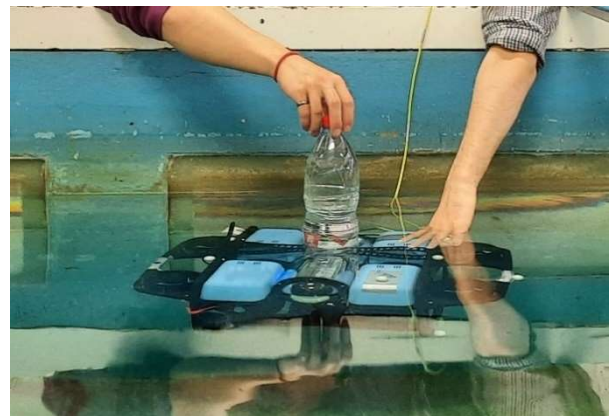
Figure 6. Pour mesurer la flottabilité du robot, les étudiants posent délicatement une bouteille pleine d'eau sur le dessus de l'engin et observent le niveau d'enfoncement de la bouteille lorsque le robot atteint un état d'équilibre. Ici les mains des étudiants servent juste à stabiliser horizontalement la bouteille et le robot mais n'agissent pas verticalement.
