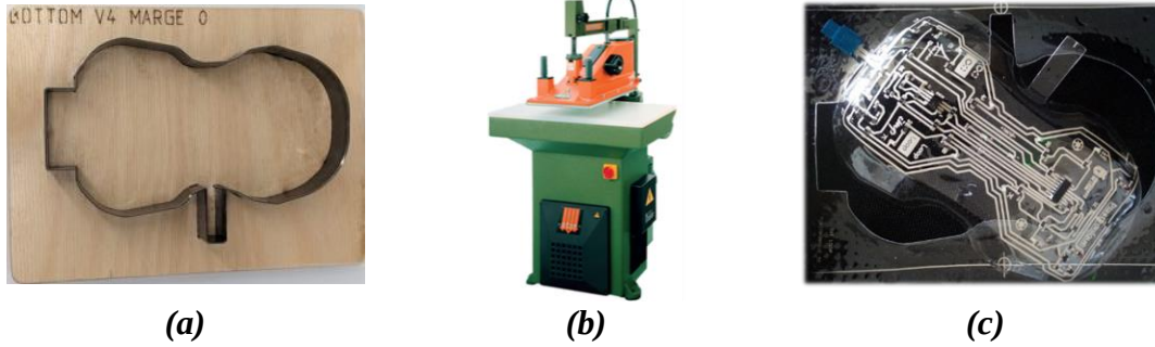
Fig.15. L'outil de détourage conçu spécialement pour la découpe des films mis en forme en 3D avec le moule « voiture » et un exemple de film thermoformé après détourage
