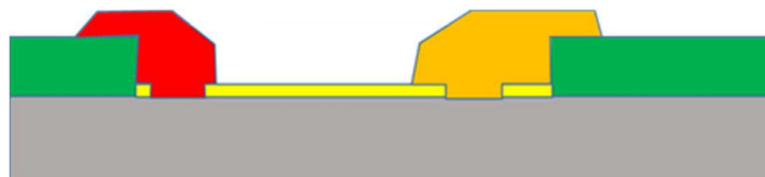
Fig.8. Vue en coupe de la diode Schottky avec le silicium en gris, l'aluminium en rouge, l'oxyde de grille en jaune et l'or en doré. Diode réalisée après un process complet de transistor.
