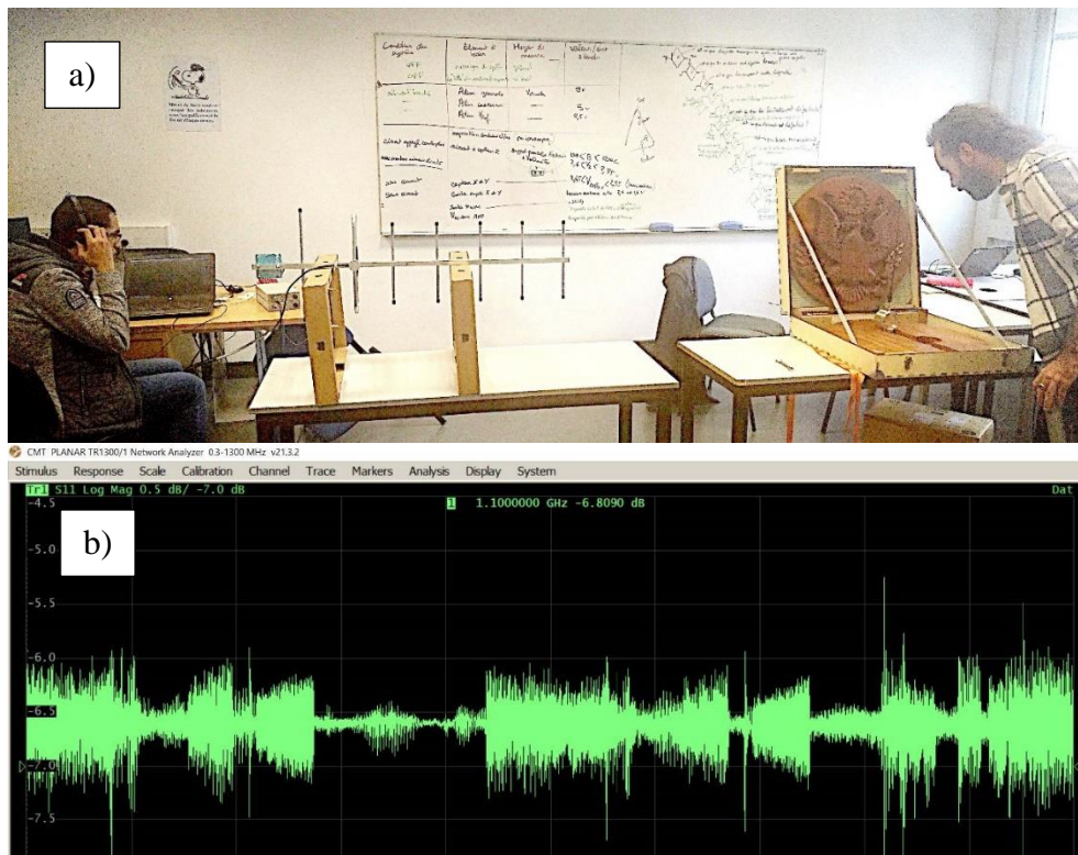
Fig.4. (a) Montage sans-fil composé d'un ordinateur pilotant un analyseur de réseaux, dont le port 1 est connecté à une antenne directionnelle. Face à cette antenne se trouve la cavité résonante et son antenne, qui module la réflexion du signal RF à la mesure du signal audio capté par la membrane de la cavité. (b) Visualisation du signal en mode ZERO SPAN (fonction du VNA pouvant être interprétée comme une démodulation d'amplitude).
