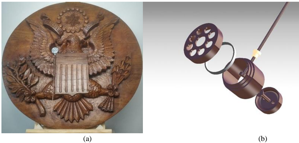
Fig.2. (a) Réplique du Grand Sceau des Etats-Unis d'Amérique (56 cm de diamètre) avec emplacement du micro espion (23cm de long), communément appelé « The Thing », « The Great Seal Bug » ou « Endovibrator » (4). (b) Vue éclatée du micro espion. La membrane métallique n'est pas représentée.
