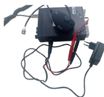
Figure 5. Remplacement de la prise pour allume-cigare par un transformateur 12 V pour alimentation du poste CB
