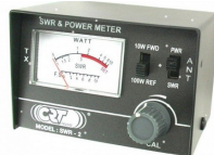
Figure 4. ROS-mètre de marque CRT utilisé en complément du poste CB
