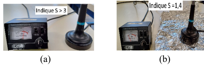
Figure 10. Mesure de ROS de l'antenne fouet CB (a) avec plan de masse (b) sans plan de masse.
