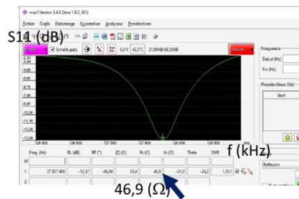
Figure 11. Interface du mini VNA Tiny, mesure du coefficient de réflexion S11 (dB) de l'antenne et calcul associé de l'impédance d'entrée.
