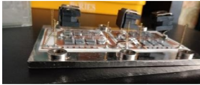
Figure 6. Module de puissance avec sa semelle, le substrat DBC (Direct Bonding Copper) et les puces de puissance brasées sur le cuivre puis câblées
