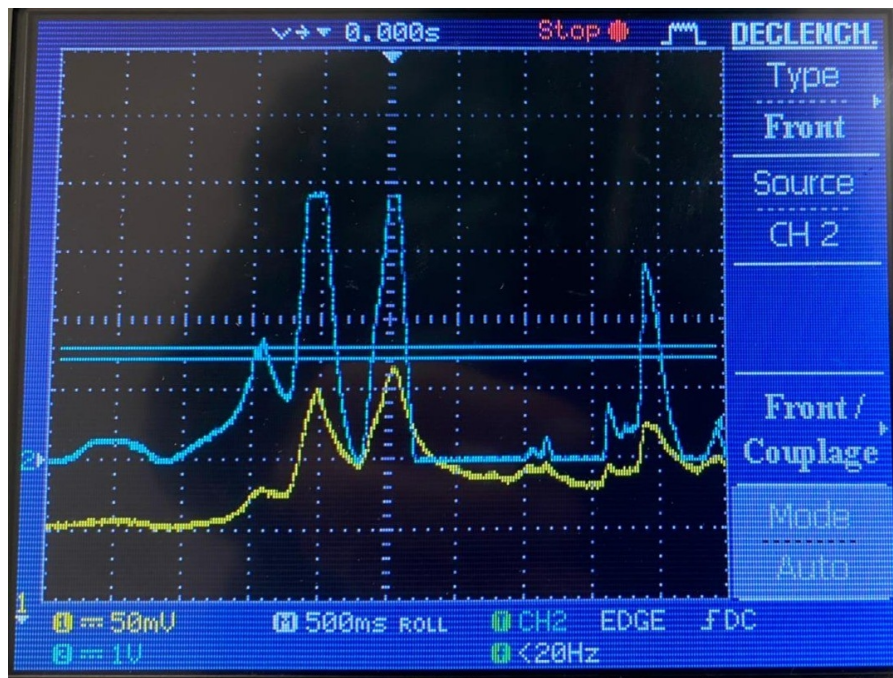
Figure 10 : Ex. d'acquisition réalisée à l'oscilloscope durant le TP montrant la comparaison des signaux en sortie de la photodiode (en jaune) et à la sortie du premier passe-bande (en bleu). On peut noter des phénomènes de saturation sur lesquels l'enseignant s'appuie pour questionner les étudiants.
